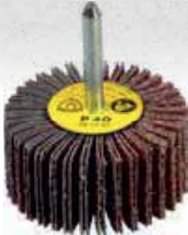
**Ventajas:** Rueda abrasiva ó cepillo mil hojas con vástago para lijadoras portátiles (amoladoras rectas) y el lijado de piezas perfiladas, superficies interiores de difícil acceso y aplicable para uso radial - Aptas para aceros al carbono y aceros inoxidables
